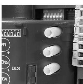
Üstteki trimmerden saat yönüne **motorun torku** arttırılır. Ortadaki trimmerden saat yönüne **engel algılama hassasiyet ayarı** arttırılır. Altta ki trimmerden **otomatik kapanma süresi** ayarlanır.
