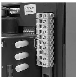
Fotosel bağlantısı için **8den 9a** atılmış köprü çıkartılır. **8-10** köprüsü kalır. Fotoselin **kontağı 9a, comu 10a** bağlanır, **enerjisi 11 ve 12ye** bağlanır.
